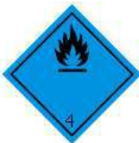
4.3 Peligroso con humedad
