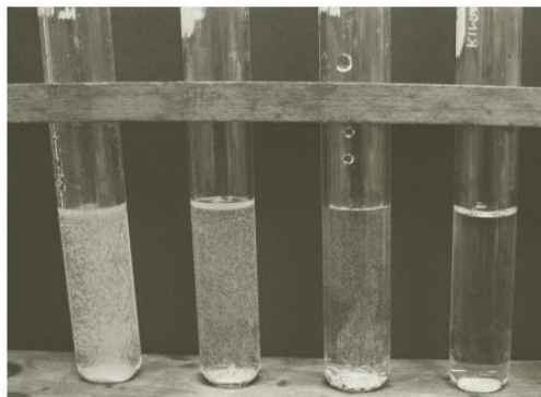
Figura 9. 1. La velocidad de reacción del zinc metálico disminuye (de izquierda a derecha) con la disminución de la concentración de ácido clorhídrico.
