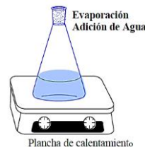
Figura 1. Evaporación paulatina de agua a partir de una solución de NaCl (0,1g/mL)
